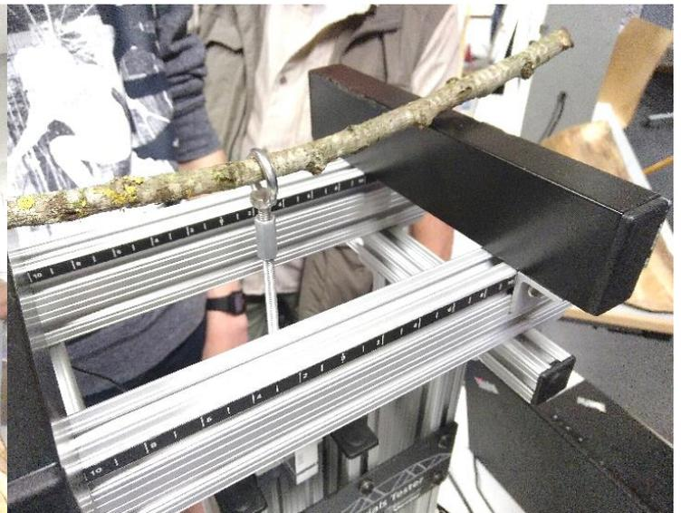
Mithilfe des Materialtesters wurden anhand von eingespannten Ästen bei verschiedenen Holzarten die Kräfte bis zum Bruch gemessen. Aus den Werten konnte die Biegefestigkeit berechnet werden.
